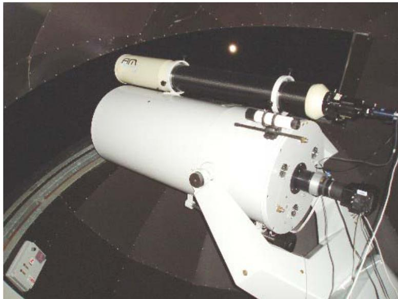
**Nell'immagine, entrambi telescopi preparati per la ripresa del transito del pianeta extrasolare XO-2b del 21 dicembre 2007. I CCD sono entrambi in posizione: il FLI al fuoco diretto del Ritechey-Chretien per riprendere la sequenza di immagini, lo Starlight SXVF-H5 al fuoco diretto del rifrattore apocromatico come autoguida.**
