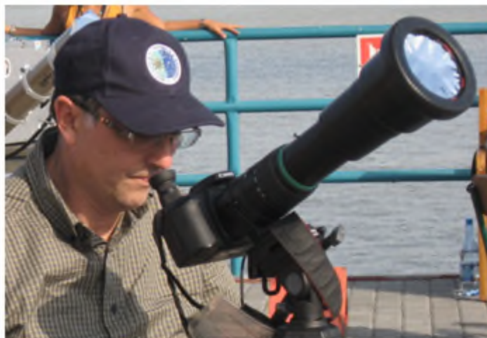
Fig. 82 – La strumentazione utilizzata per riprendere l'eclisse: fotocamera digitale Canon 20D, ottica Sigma Apo 170/500mm utilizzato a 500mm con filtro Astrosolar per le fasi parziali
